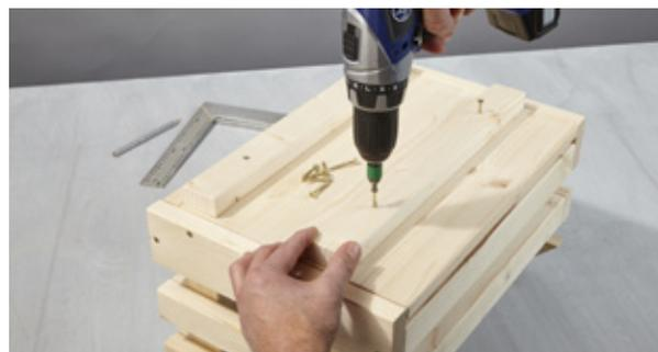
An den oberen beiden Kisten werden unten je zwei Hölzer angebracht, die dafür sorgen, dass die Kisten beim Stapeln „einrasten“.
