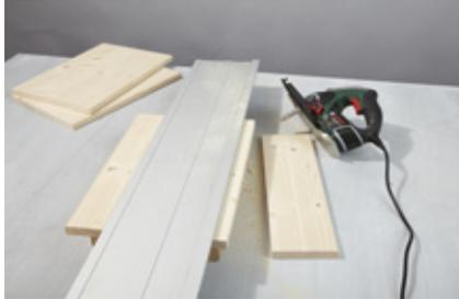
**2. Alternativ zum Zuschnitt im Baumarkt** können die Platten auch selbst zugesägt werden. Für einen geraden Schnitt sollte dann eine Führungsschiene verwendet werden.
