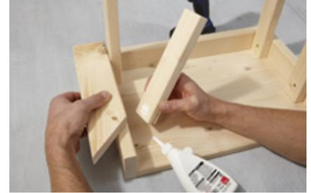
**12.** Die vertikalen Hölzer mit etwas Leimzugabe anschrauben. Die vorderen Hölzer so weit nach hinten einrücken, dass die vertikale Leiste später nicht die Schräge der obersten Leiste überragt.
