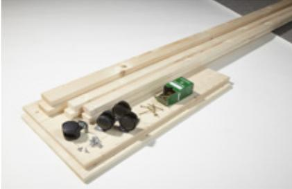
**1. Material:** Die Stapelkisten werden aus unterschiedlich breiten Fichtenleisten und Böden aus 18-mm-Fichte-Leimholzplatten gefertigt. Die Böden lassen sich im Baumarkt auf Maß geschnitten kaufen.
