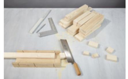
**3. Die Leisten nach Materialliste** zuschneiden. Wer keine Kreis- oder Kappsäge hat, kann mit einer Gehrungslade plus Feinsäge arbeiten.
