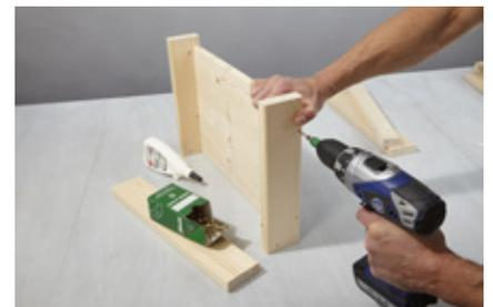
**9. Leisten durch die vorgebohrten Löcher** anschrauben.
