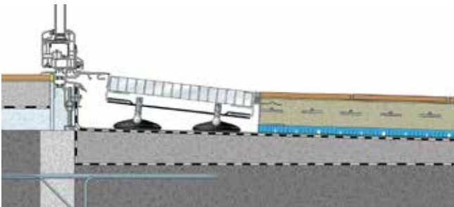
Schwelldreieckige Übergänge zur Terrasse sind bei Schlagregen besonders gefährdete Zonen. Hier sind ausgefeilte Entwässerungssysteme gefragt. Abbildung: Gutjahr
