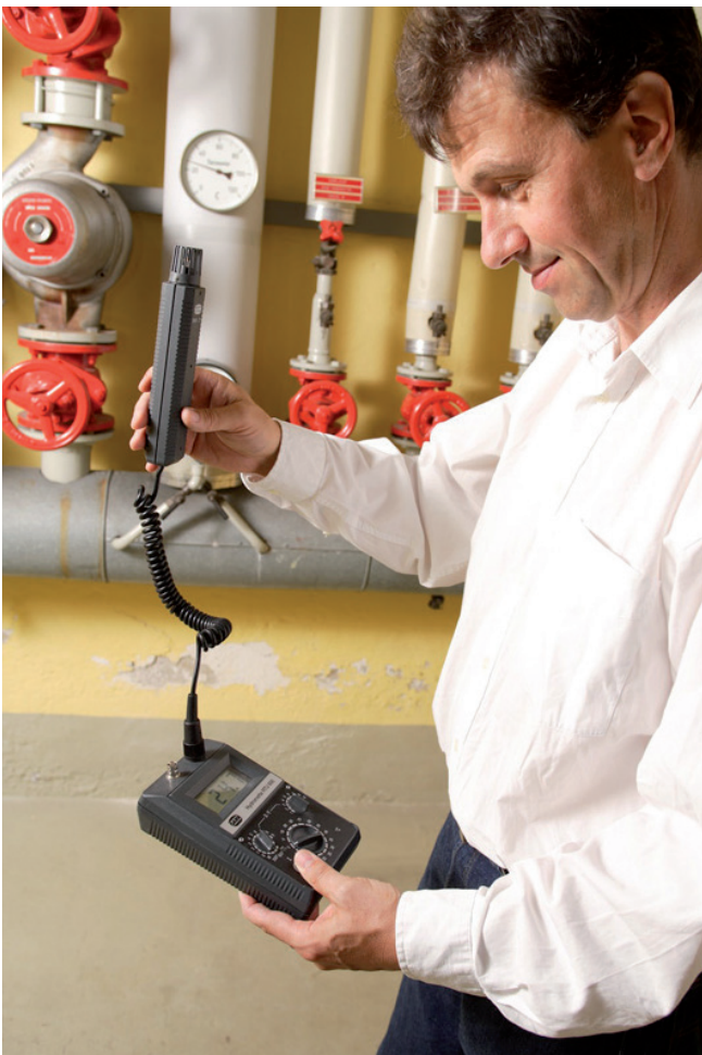
0218 - 118 Zu viel Feuchte führt zu Schimmelbildung. Hier wird mit einem elektronischen Messgerät mit Feuchtesensor die relative Luftfeuchtigkeit gemessen.
