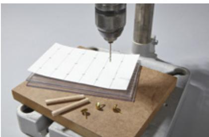
**4.** Position der Bohrungen auf die Acrylglasplatten übertragen. Den Durchmesser des Bohrlochs etwas größer als den des Nagelstifts wählen. Vorsichtig bohren: mittlere Drehzahl, sehr wenig Druck – damit die Platten nicht brechen.
