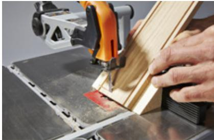
**2.** Die so hergestellten Teile auf Gehrung schneiden. Das geht per Stichsäge mit Stichsäge Tisch: Ein auf 45 Grad zugesägtes Holzstück am Anschlag unterlegen. Oder mit Kreis- oder Kappsäge arbeiten. Auch die drei Elemente des unten eingeleimten Abrollblocks zuschneiden.
