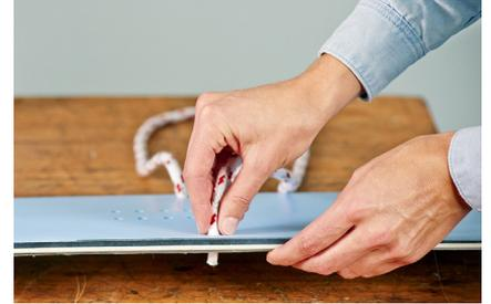
3. Das Seil durch die Löcher führen und mit je einem Knoten an der Unterseite des Bretts fixieren. Die Seilkonstruktion dient später als Aufhängung.
